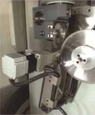
Patentli mikrostep sıkma ile otomatik et kalınlık, mesafe ve tork ayar imkanı
