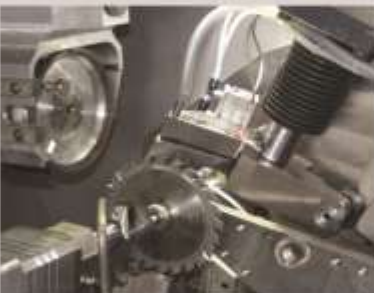
Akıllı tırmak ile otomatik kırıntı atılma ve şaşırtmalı diş adımlarını otomatik itme. Çift parçalı çizicileri tek seferde bilemek için Opsiyonel Pnömatik Sistem
